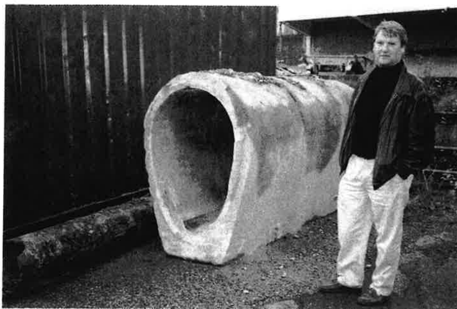
Dette betongrøret fra Bergen er et eksempel på, at betongrør normalt har meget god bestandighet og lang levetid. Røret ble støpt en gang i tidsrommet 1905–1915.
